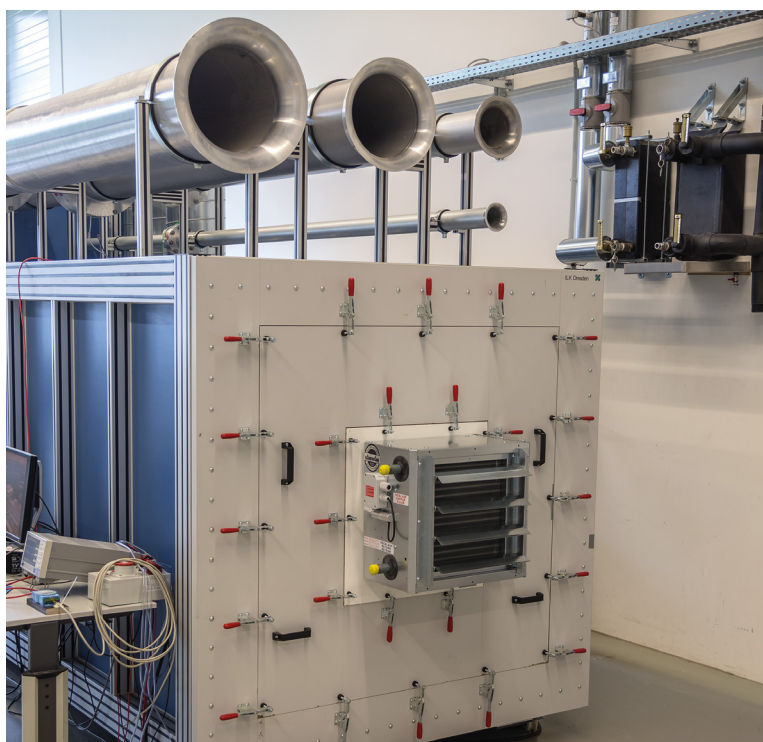
Kammerprüfstand für Luftleistungsmessungen nach DIN EN ISO 5801, Kampmann F&E Center
